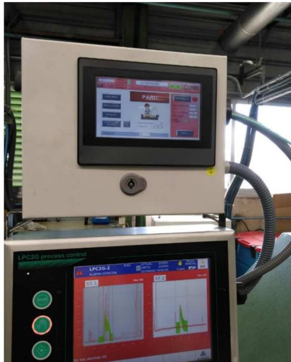
Armario de control de la estampadora con pantalla HMI integrada
