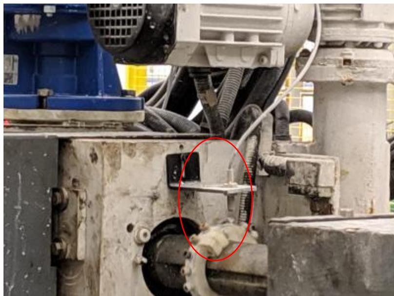
*Imagen: Sensor inductivo para el cálculo de la velocidad de la línea.*
