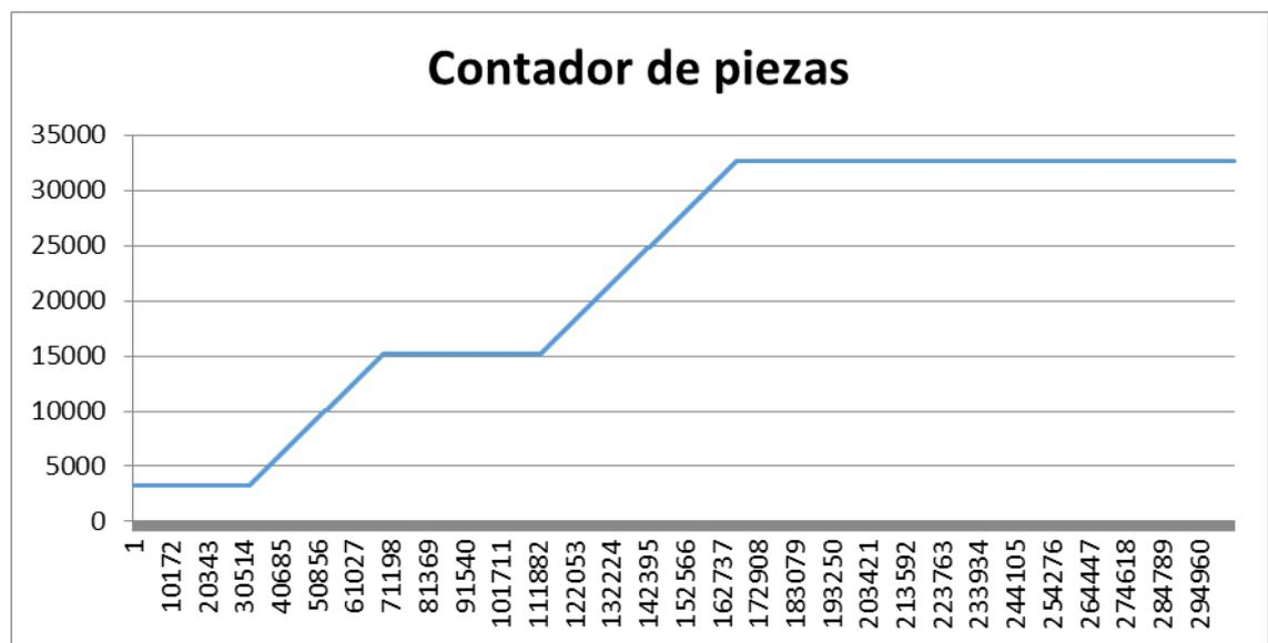
Tasa de producción de la máquina estampadora (piezas fabricadas vs marcas de tiempo).
