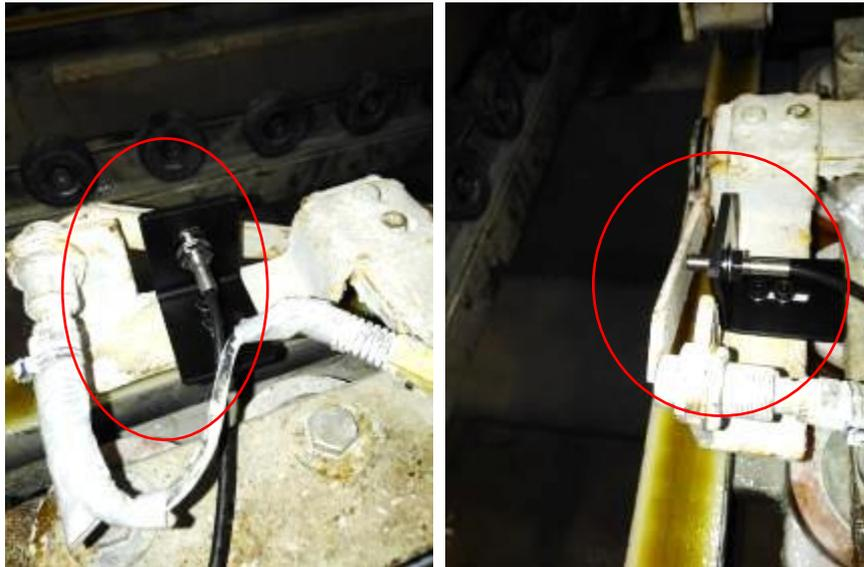
*Imagen: Sensor inductivo para el cálculo del paso de piezas*
